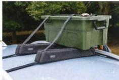
今回は、OGC製のラゲッジボックス(参考価格¥4,400)を積載する方法を紹介する。まずはソフトキャリアの上にラゲッジボックスを載せる
