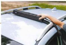
車両のドアを開け、ルーフにソフトキャリアを載せる。車内側に取りまわすベルトをドア側に垂らしておく
