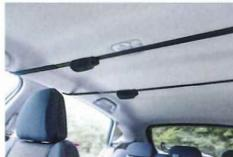
後方のソフトキャリアも位置確認しながら、同様に取り付け。これでソフトキャリアの取り付けは完了
