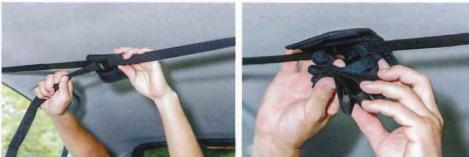
バックルにベルトを通し、締め付けていく。ソフトキャリアの位置を調整し、余ったベルトをまとめてベルトホルダーで束ねる
