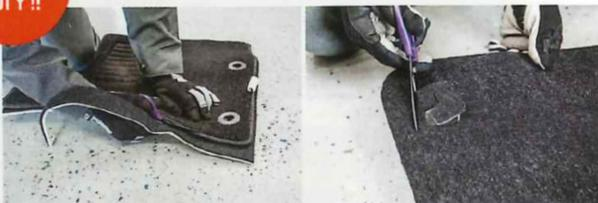
純正フロアマットの形状にあわせて型取りし、ハサミを使ってシートを裁断。あとはフロア面に貼り付けるだけ。厚さは約9mmなのでマットを固定するための穴空けもカンタンにできる。今回のトヨタ・プロボックスでは1シートでフロント2席分が確保できた
