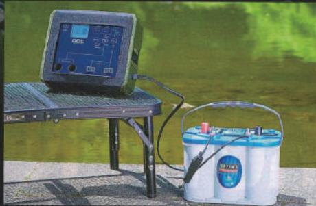
本体側面の差し込み口にソケットを差し込み、ディープサイクルバッテリーと接続する。接続するコード長は1.5m。バッテリーは机下へ。
