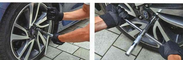
●回転機構付きのハンドルで作業性も抜群。もちろんクロスレンチモードでナットの仮締めも可能。本締めはトルクレンチを使用すること
