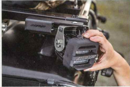
●ルーフラックパネルに刻んだスリットへのIPFランプの取り付け例。写真上は40インチライトバー、下は発売予定の首振りブラケットを使いワーキングランプを装着
